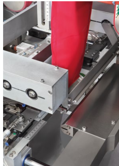
Detail of sealing systems. Dettaglio del gruppo di saldatura.
