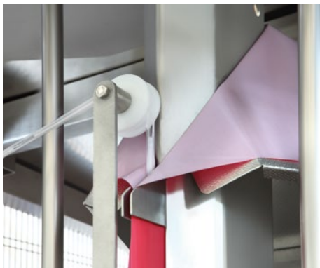
Detail of forming tube. Dettaglio del tubo formatore.
